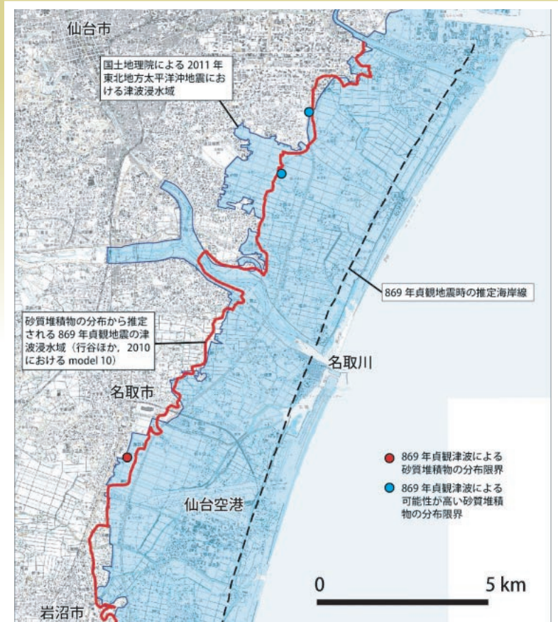
図1 仙台平野中北部における869年貞観地震と2011年東北地方太平洋沖地震との津波浸水域の比較。
