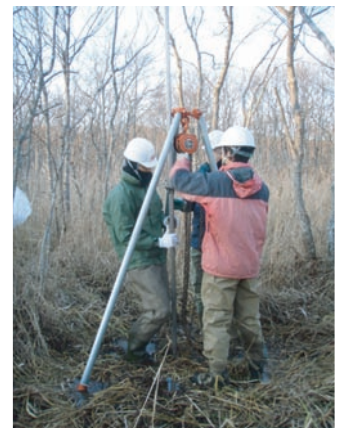
写真1 ハンディジオスライサーを用いた掘削調査の様子
