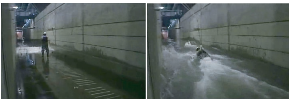
写真5 津波による人体流下実験の様子。
