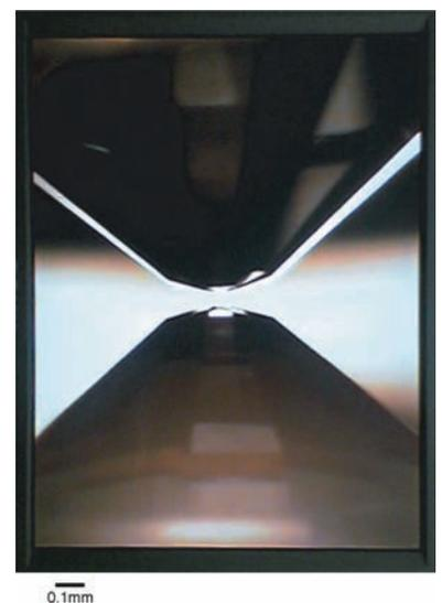
写真 超高压を発生するダイヤモンドアンビルの先端部。先端の直径は60ミクロン。
