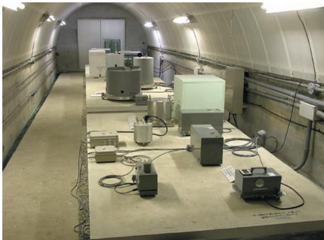
写真2 各種地震計（左）と石英管式歪計の南北成分（右）
