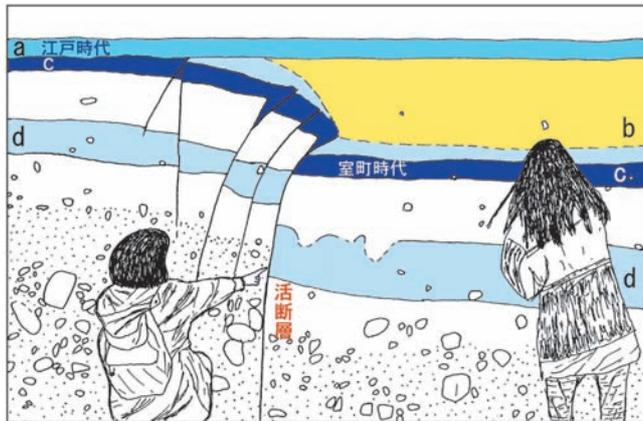
図2 真上断層のトレンチ調査（表紙写真参照）。a：近世の耕作土の床土、b：断層活動の後で運んだ盛土、c：鎌倉～室町時代の耕作土、d：奈良～平安時代の耕作土
