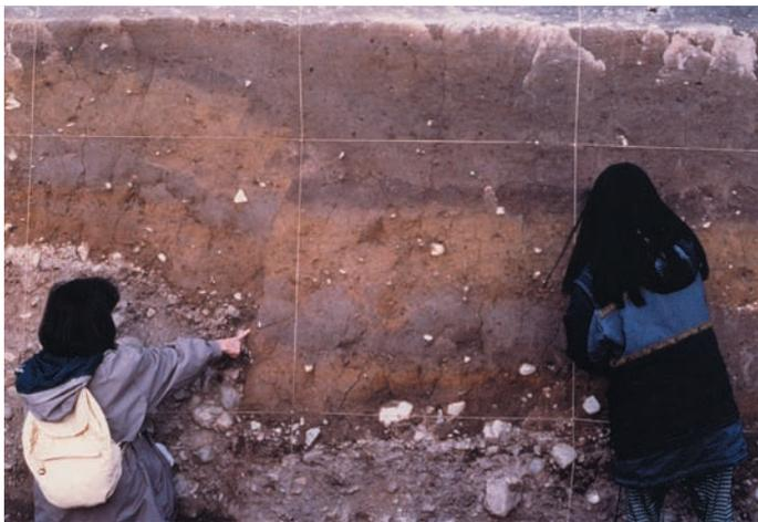
写真：工業技術院地質調査所が1995年度に行なった有馬・高機構造線活断層系のトレンチ調査で、中世の耕作土が上下に食い違った状態がはっきりと確認できました。この断層活動は、1596年に発生して京阪神・淡路地域に大きな被害を与えた「伏見地震」に対応すると考えられます。詳しくは、p.4-6の記事「近畿の活断層と古地震(活断層お国めぐり 第5回)」をご覧ください。なお、地質調査所による活断層の調査は、2001年度から、独立行政法人産業技術総合研究所活断層研究センターに引き継がれています。
