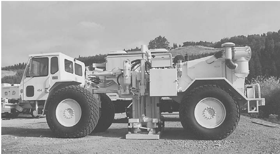
反射法探査の際に用いられるバイブレーター (Y-2400)。大規模な探査においては複数台用いられることもあります (写真提供：(株)地球科学総合研究所)。
