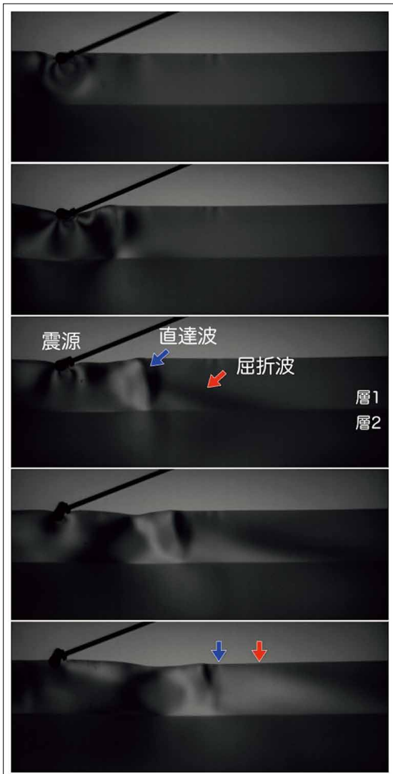
写真4 実験のスナップショット（層1は濃度1%、層2は濃度3%のゲル。各画像の間隔は5ミリ秒）
