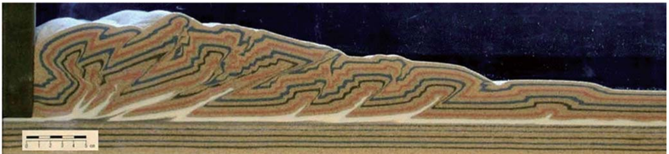
実験によって再現された付加体。詳しくは p.4 からの記事「プレート沈み込みにともなう付加体の再現」をご覧ください。
