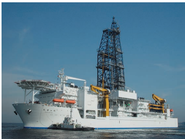
写真 「ちきゅう」。全長210m、排水量57,000トンの巨大な船。
