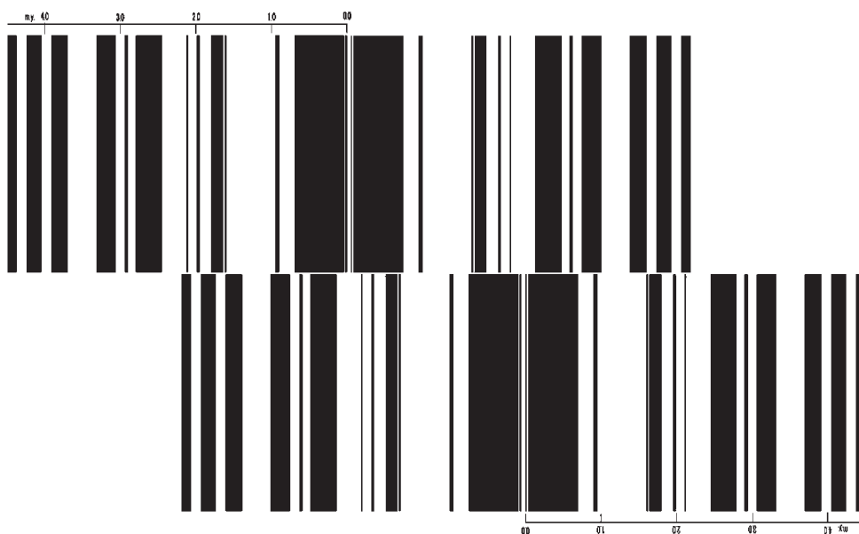
図1 トランスフォーム断層ペーパーモデル型紙（カッターで、両端を残しながら、水平に切れ目を入れます）。
