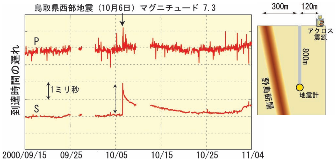
図1（左）鳥取県西部地震（2000年10月）の時に淡路島でアクロスを用いて観測されたS波到達時間の変動。遠方からの地震波の到来と同時にアクロス震源から地震計までのS波の到達時間が遅れ、その後、しだいに元に戻りました。（右）野島断層、アクロス震源、地下800mに設置された地震計の位置関係（断面図）。
