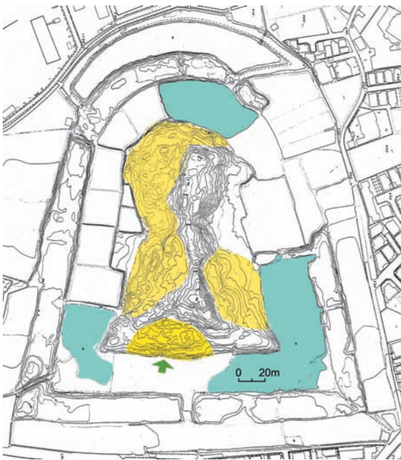
図4 今城塚古墳の地滑り地形。墳丘で、顕著に崩れ落ちたことが地形的にわかる部分を黄色で示しています。矢印の部分で行われた高槻市教育委員会の調査で、地滑り跡が連続的に確認できました。高槻市教育委員会作成の地形図を基図にしています。
