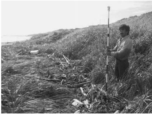
左写真：津波による漂着物（津波堆積物）の海面からの高さを測る様子。堆積物の左側の草が津波で倒れている。右写真：津波の直線的な跡が建物の白い外壁に残っている（矢印の位置）。（共に、北海道大学西村裕一氏撮影）詳しくは、p.3の記事「2003年十勝沖地震で発生した津波」をご覧ください。
