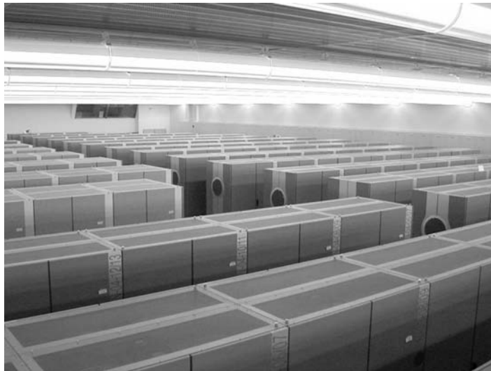
地球シミュレータのコンピュータシステム。50m×65mの部屋に320個のコンピュータの箱が並んでいる。一つの箱には16個のプロセッサが納められており、全部で5120個のプロセッサから構成される。(詳しくは、p.6-7の記事「地球シミュレータと固体地球科学大規模シミュレーション」をご覧ください)
