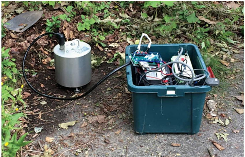
図4 本震発生直後から実施した臨時の余震観測の様子。写真は地震計とポータブル地震観測装置。
